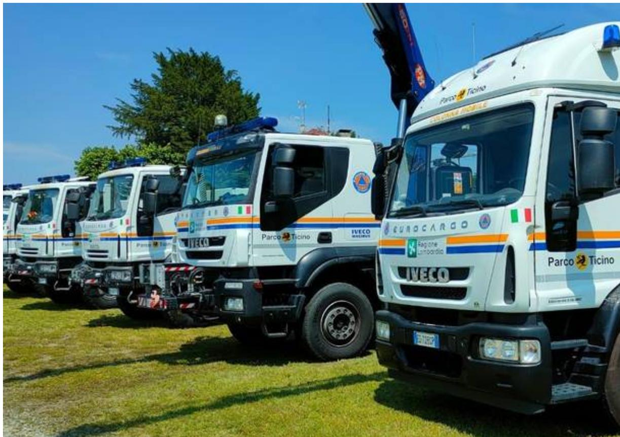
**Gli Eurocargo sono tre e sono mezzi polivalenti**, ovvero possono montare più moduli in base alle esigenze (come moduli attrezzati ad **utilizzo idrogeologico**, **tende di alloggiamento** o autobotti di **trasporto acqua** non potabile per uso incendio o rifornimento idrico).
